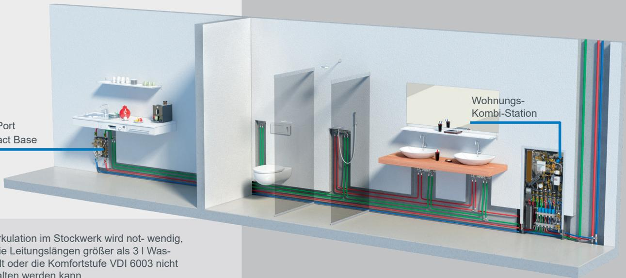
Eine Zirkulation im Stockwerk wird notwendig, wenn die Leitungslängen größer als 3 l Wasserinhalt oder die Komfortstufe VDI 6003 nicht eingehalten werden kann.
