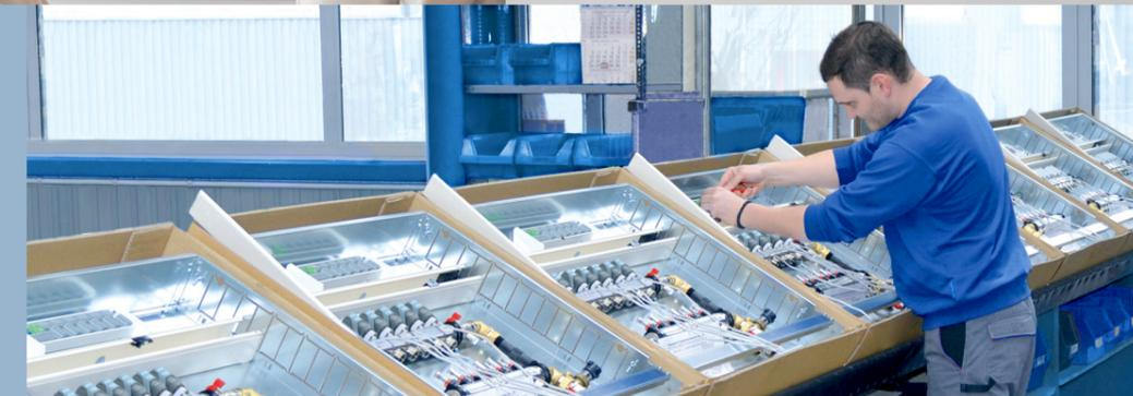
Uponor Kamo bietet ein umfangreiches Programm an Verteiler- und Mess-Stationen. Heizkreisverteiler, wahlweise in Edelstahl- bzw. Kunststoff, werden komplett in Unter- oder Aufputzschränken vormontiert und sind kurzfristig ab Lager lieferbar.
