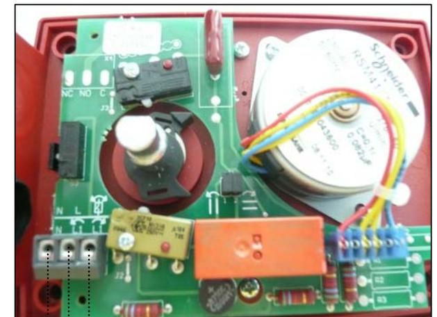
Eingang N Antrieb auf Ausgang N Frischwasserregler
