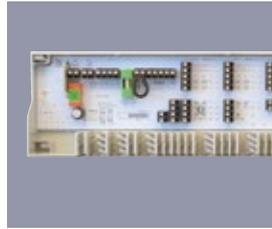
Regelverteiler Standard Plus 230 V Anschluss von 6 bzw. 10 Raumthermostate mit max. 15 Stellantrieben 230 V. Zusätzlich Heizen/Kühlen inkl. integrierter Pumpenlogik. Überlastungsschutz durch auswechselbare Feinsicherung, Anschlusskabel notwendig.
