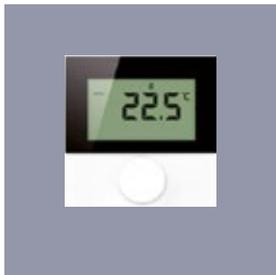
Raumtemperaturregler Display 230 V Einstellbereich 5-30 C, Schaltdifferenz ca. 0,5 K. Auflösung Solltemperaturvorgabe in 0,5C. Bedienung über Drehknopf mit Dreh-Drück-Mechanik. Beleuchtetes LC-Display. Sprachneutrale Bedienung und Benutzerführung. Begrenzung des Temperatureinstellungsbereichs. Bediensperre und Eingang für externes Absensignal.
