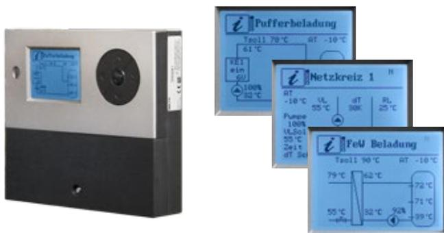
Heizkreise mit / ohne Mischer mit 24V (Trafo bauseitig) Spannungsversorgung und 0-10V Stellsignal bzw. 230V 3-Punkt und 0-10V Ansteuerung der Heizungspumpen. Die KaMo Combi-Control-Regelung gewährleistet die Steuerungsfunktion der Heizkonzepte bei 2-Leiter-, 3-Leiter- und 4-Leiter-Anlagen.
