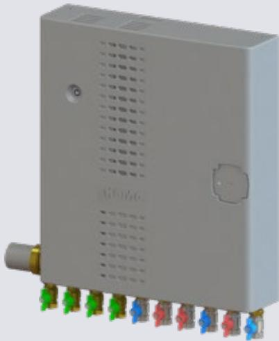
Durch den einzigartigen Aufbau in einem EPP Isoliergehäuse werden die Wärmeabstrahlverluste deutlich minimiert und durch das konsequente Separieren der trinkwasserführenden Bauteile von der Heizung wird ein unnötiges Aufwärmen des kalten Trinkwassers vermieden.
