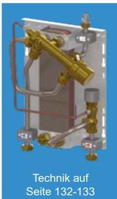
Stationen mit werkseitig festgelegter Ausstattung zur Versorgung von Wohnungen mit Frischwarmwasser. Speziell für entfernte Entnahmestellen wie z. B. Küche, Bad und Gäste-WC. Das Warmwasser wird bedarfsgerecht direkt an der Entnahmestelle bereitgestellt, wodurch auch bei weiter verzweigten Stockwerksinstallationen keine Warmwasserzirkulation notwendig ist. Alle Hochleistungsplatten-Wärmetauscher mit spezieller ConBraze Prägung.
