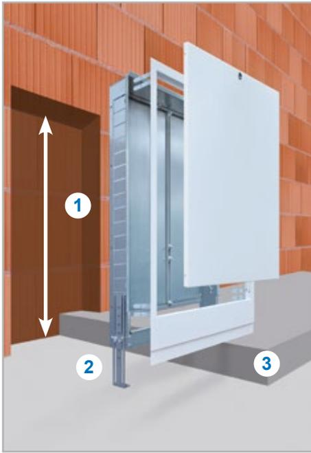
Die modular aufgebauten Wohnungsstationen bieten dem Installateur enorme Montagevorteile. Eine Vorablieferung der Anschlussschiene inkl. den Kugelhähnen ermöglichen bereits in der Rohbauphase das Anschließen bzw. Spülen/Befüllen aller Rohrleitungen. Im zweiten Schritt wird das Grundgerät aufgesetzt und mit der Anschlussschiene verbunden.
