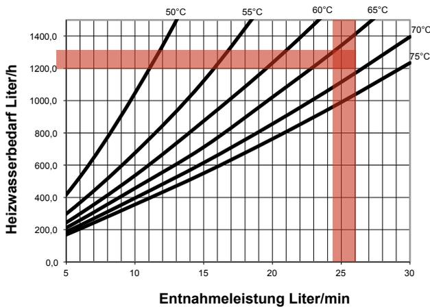
Trinkwassererwärmung um 40 K (10 - 50°C)
